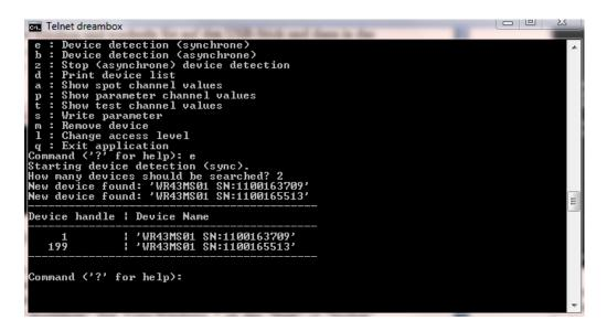
Die gefundenen Wechselrichterangaben entsprechen natürlich denen Ihrer Anlage. Es wird der Typ und die Seriennummer angezeigt. Merken Sie sich die Zahlen in der Spalte "Device handle". Drücken Sie nun die Taste a, um Messwerte abzufragen. Sie werden nun nach dem "Device handle" (Wechselrichter) gefragt, der abgefragt werden soll. Geben Sie eine Zahl aus der Spalte "Device handle" an.
