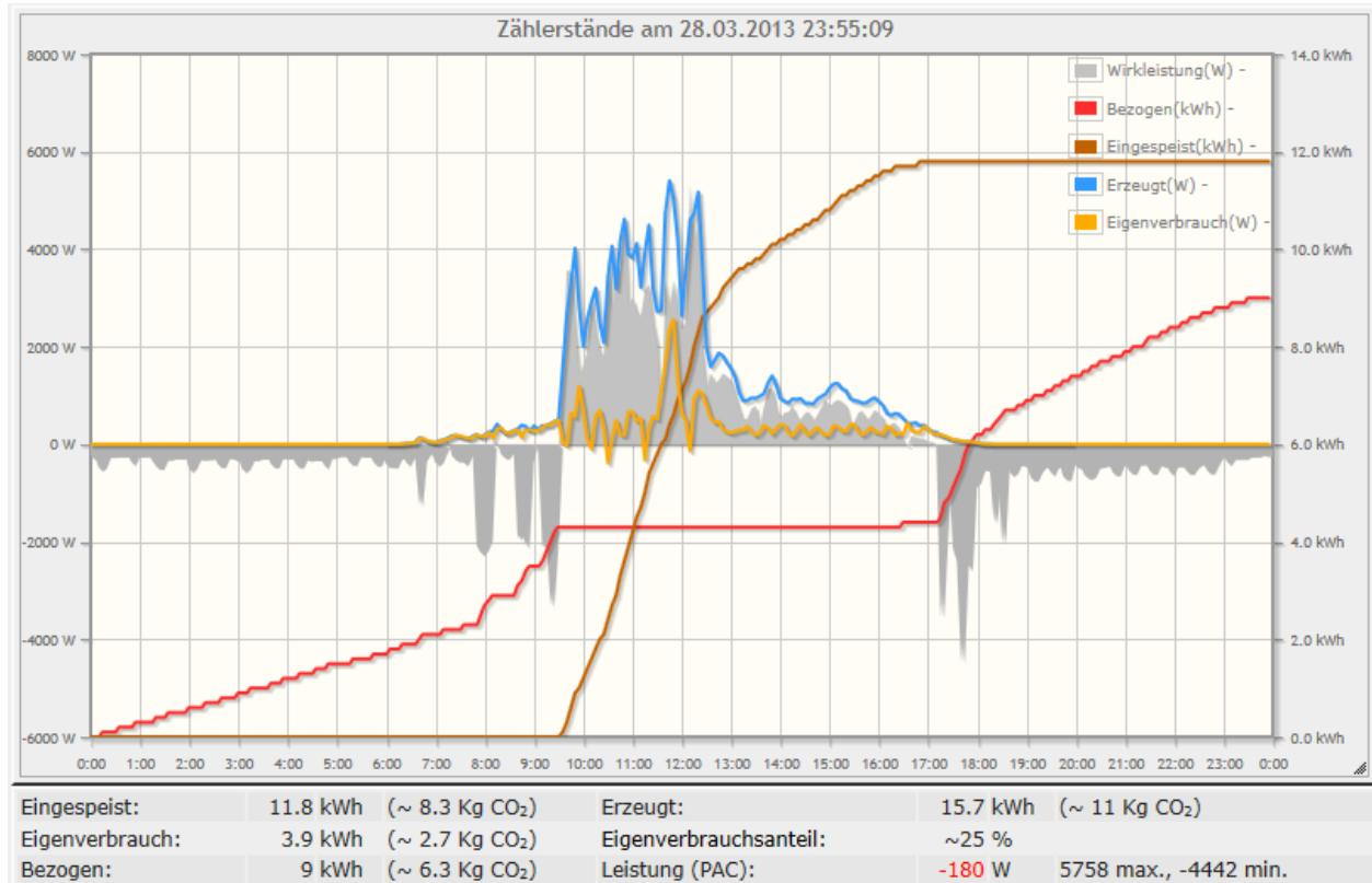
Bei der grauen Kurve handelt es sich um die am Zähler erfasste Wirkleistung, die rote Kurve zeigt die über den Tag bezogene Energie, die braune Kurve zeigt die eingespeiste Energie an (erzeugte Energie weniger selbst verbrauchte Energie). Man sieht hier schön, dass zwischen ca. 9:30 und 17:10 der Energiebedarf komplett aus der selbst erzeugten Energie bezogen wurde.
